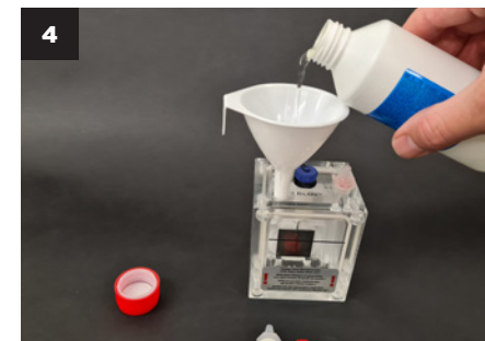
Coloque el embudo en la primera cámara y vierta la solución de clorito de sodio hasta la línea indicada en el generador.
