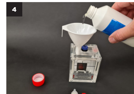
Zasuňte trychtýř do první komory a nalijte chloritan sodný až po rysku na generátoru.
