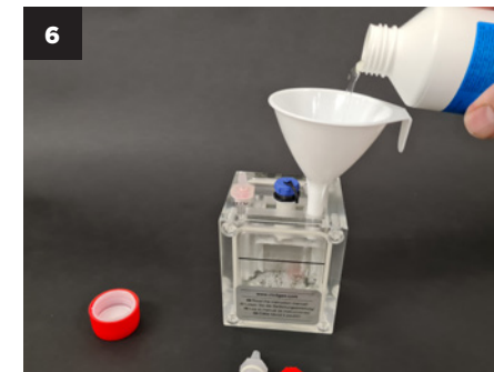
Následně naplňte chloritanem sodným druhou komoru generátoru.
