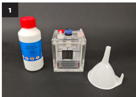
Przygotuj generator, lejek i roztwór chlorynu sodu.
