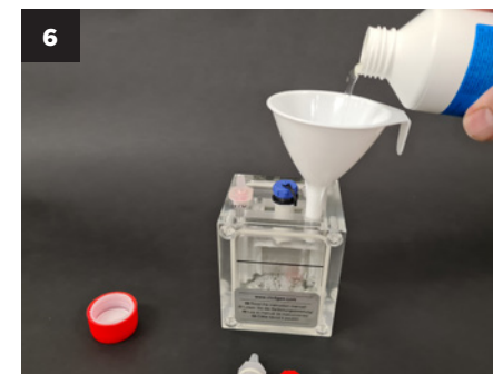
Remplissez ensuite la deuxième chambre du générateur avec du chlorite de sodium.
