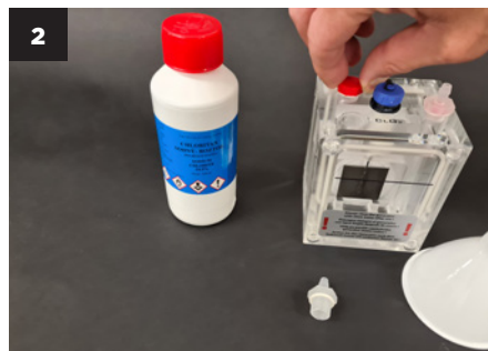
Odšroubujte oba otvory pro nalití chloritanu sodného do komor generátoru.
