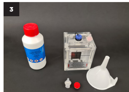
Bouchons dévissés, générateur prêt.
