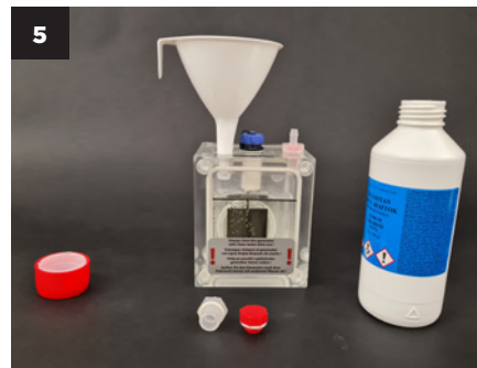
Bis zur Markierung gefüllt – in Ordnung.
