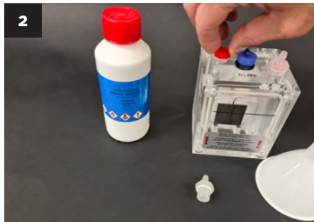
Schrauben Sie beide Öffnungen zum Einfüllen von Natriumchlorit in die Kammern des Generators ab.
