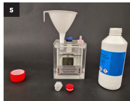
Relleno hasta la línea, correcto.
