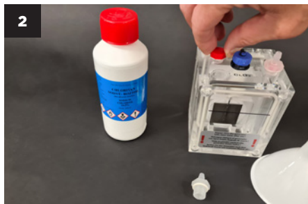
Dévissez les deux bouchons obturant les orifices permettant de remplir les chambres du générateur avec le chlorite de sodium.
