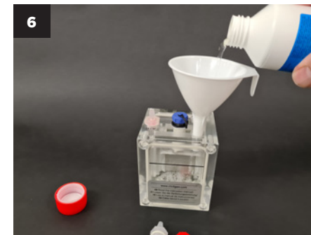
Następnie napełnij drugą komorę generatora chlorynem sodu.
