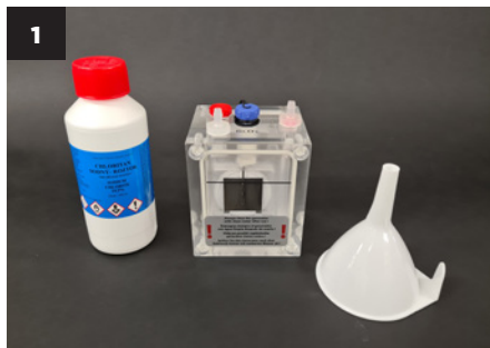
Prepare el generador, el embudo y la solución de clorito de sodio.
