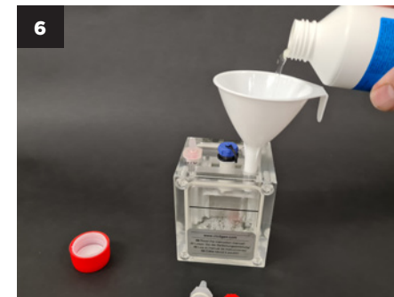
Füllen Sie dann die zweite Kammer des Generators mit Natriumchlorit.
