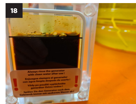
18 Color del relleno del generador en pleno funcionamiento.
