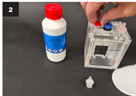
Desenrosque las tapas de los dos orificios para verter la solución de clorito de sodio en las cámaras del generador.
