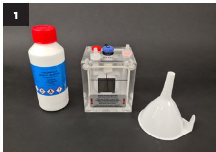
Bereiten Sie den Generator, Trichter und die Natriumchlorit-Lösung vor.
