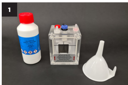
Préparez le générateur, l'entonnoir et la solution de chlorite de sodium.
