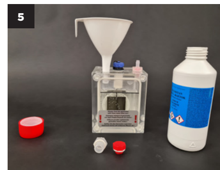
Remplissage jusqu'au repère – tout est OK.
