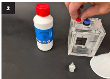
Odkręć oba otwory do wiania chlorynu sodu do komór generatora.
