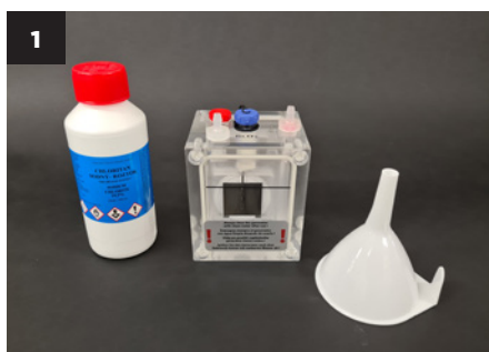
Przygotuj generator, lejek i roztwór chlorynu sodu.
